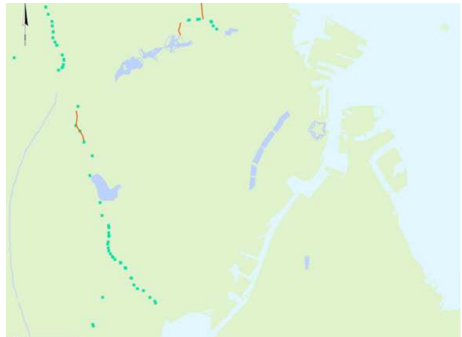
Figur 7.4. Krav til indsats i Statens Vandsplaner i perioden frem til 2015. Kortet er en kopi fra Statens Vandplan (GIS-kort). De grønne prikker viser overløbsbygværker, hvorfra overløbene fra kloakken skal nedbringes. De røde streger viser vandløbsstrækninger, hvor der skal ske ændret vedligeholdelse. Den røde nordligste streg er Gentofterenden i Gentofte Kommune og er altså ikke et krav til indsats i Københavns Kommune. På kortet vises også grønne prikker fra nabokommunerne. For visning af overløbsbygværker alene i Københavns Kommune henvises til figur 7.3.
