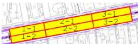
Figur 5-29 Eksempel på opdeling af strækning i delarbejdspladser.
