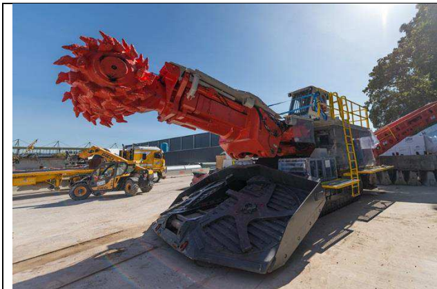
Figur 7-22 En Roadheader som anvendes til at fræse NATM kaverne ud i f.eks. kalklag.
