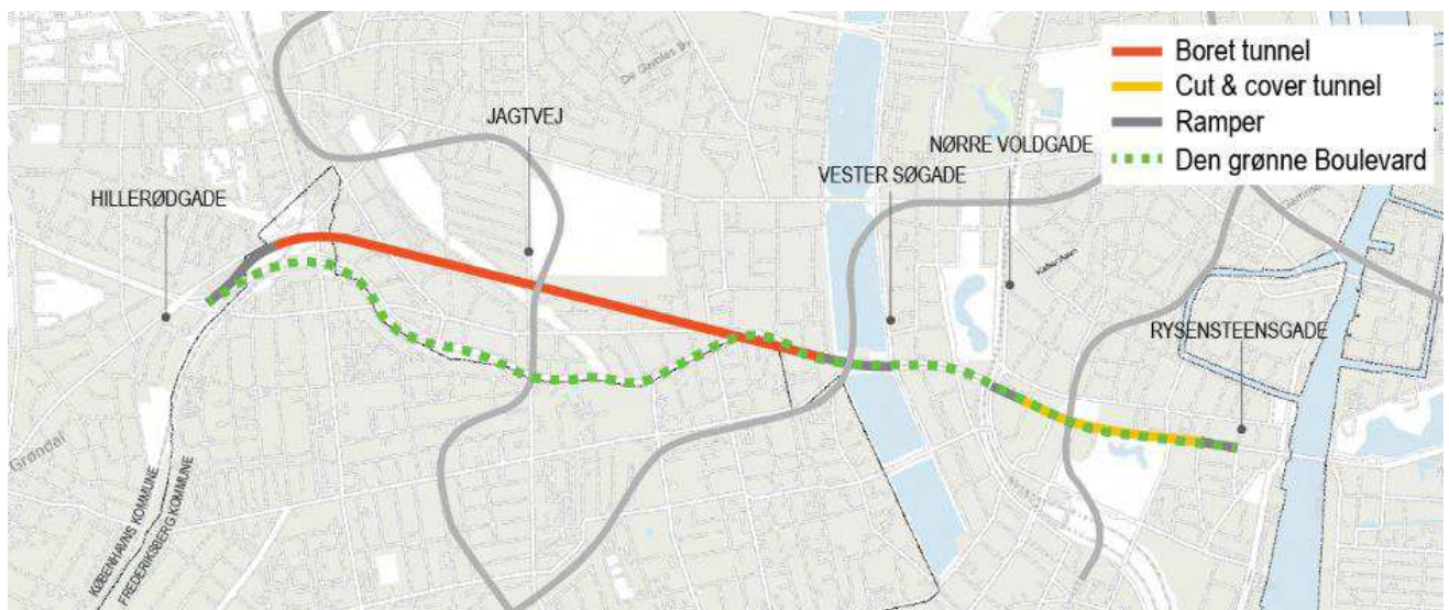
Figur 1-1 Hovedforslaget mellem Borups Allé og Rysensteensgade
