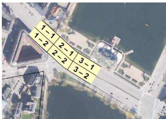
Figur 4-12 Eksempel på opdeling af strækning i delarbejdspladser,
