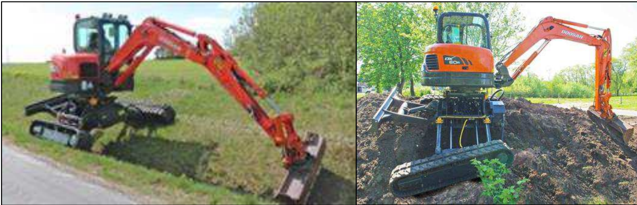
Figur 3-25. Eksempler på specialmaskiner med klippende og forskudte bæltter.
