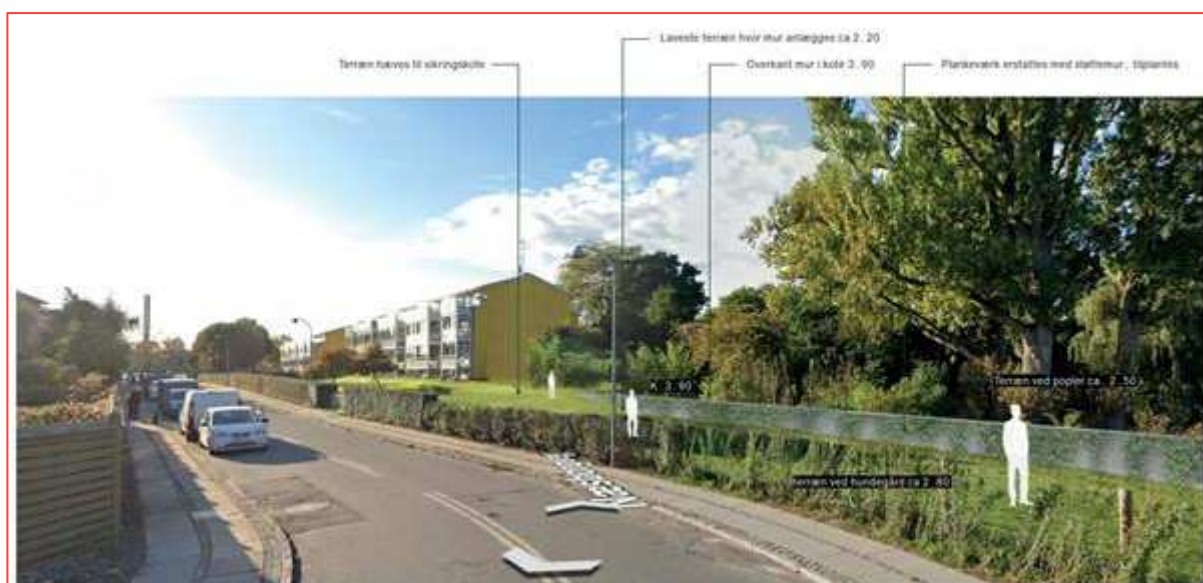
Figur 3-20 Foreslået princip for højvandssikringen langs Næsborgvej.
