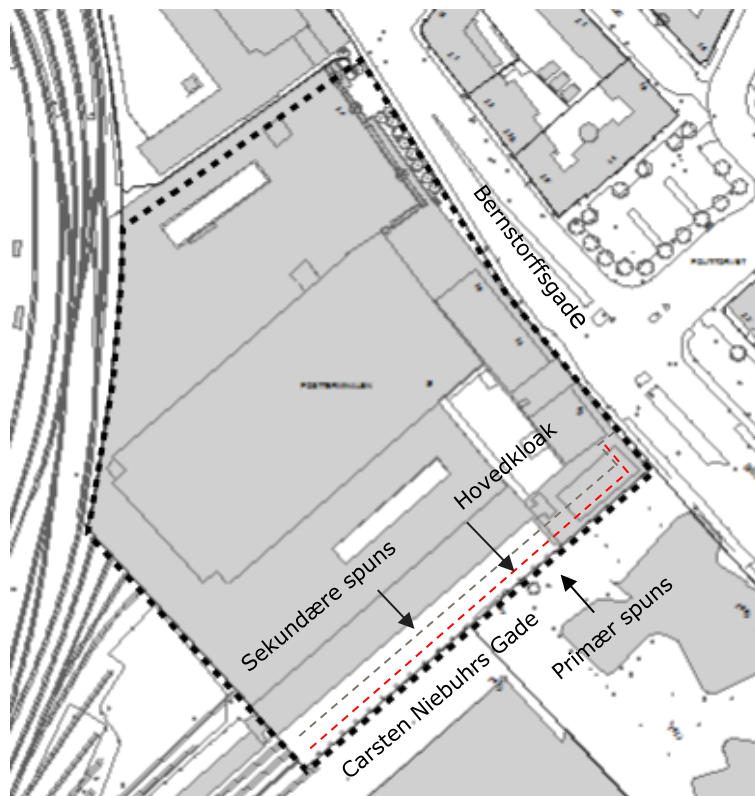
Figur 9-3 Placering af primærspuns, sekundærspuns og hovedkloak
