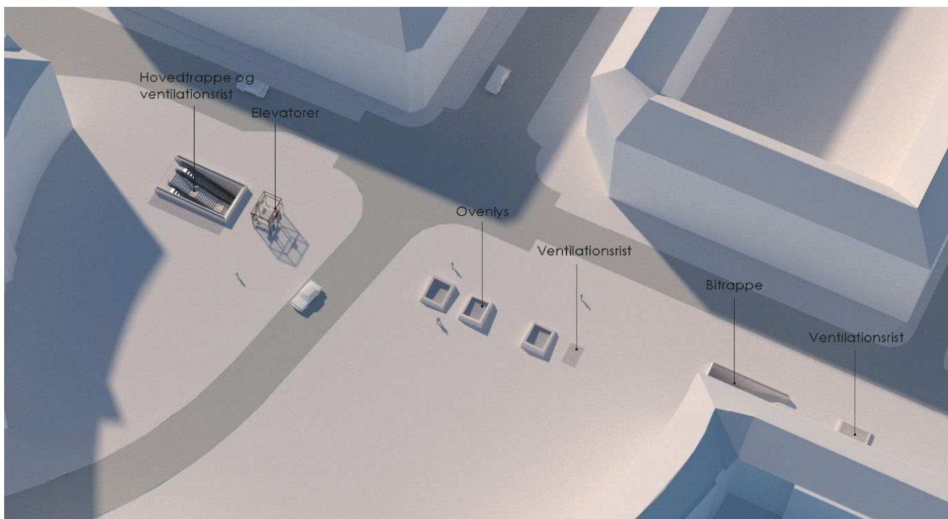
Illustration, der viser de faste metroelementer, deres funktioner og placering på pladsen. Illustration: Arkitema Architects.
