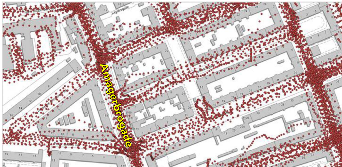
Figur 1: Udsnit af rådata for Amagerbrogade og sidegader. Hver prik er en måling, der foretages hvert sekund. På de endelige kort er målinger aggregeret til vejstrækninger på ca. 30 meter. En vejstrækning indeholder adskillige enkeltmålinger. Målinger hen over bygninger er udtryk for afvigelser i gps-signal, som er korrigeret i den efterfølgende databehandling.
