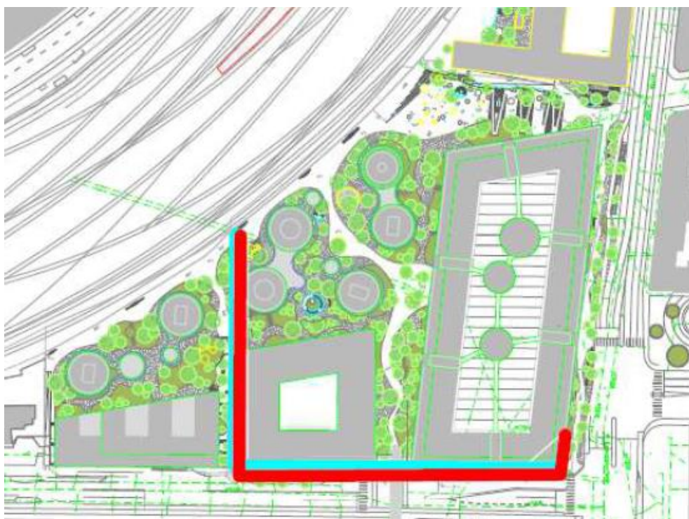
Figur 13-8 Principskitse for hvorledes hovedkloakledningen kan omlægges (rød og turkis linje)
