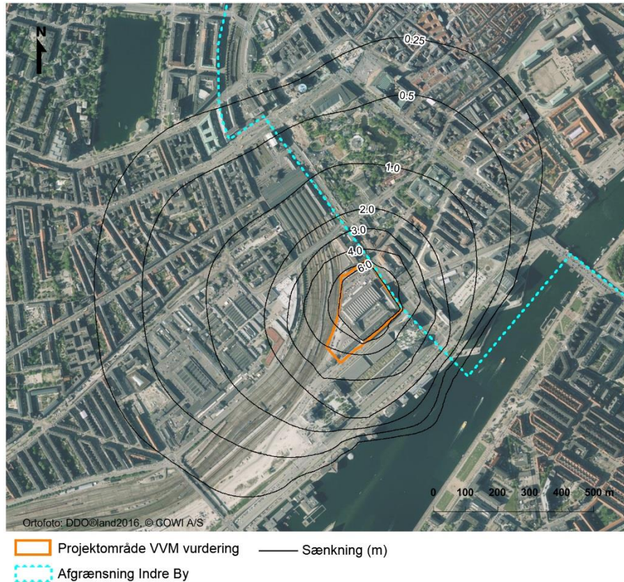
Figur 13-4 Eksempel på grundvandssænkning i det primære magasin i kalken med afskærende væg 4 m ned i kalken men uden reinfiltration .
