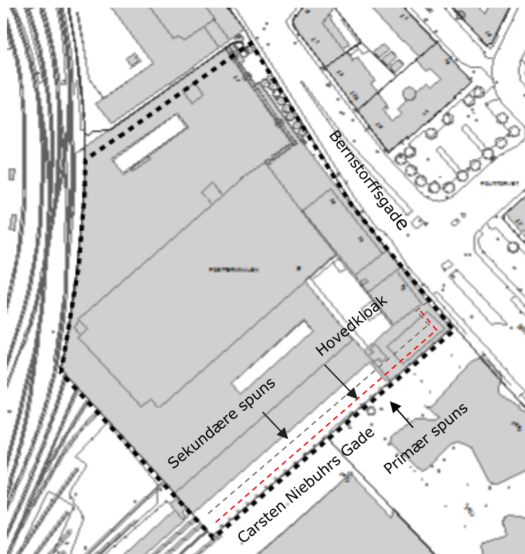
Figur 9-3 Placering af primærspuns, sekundærspuns og hovedkloak
