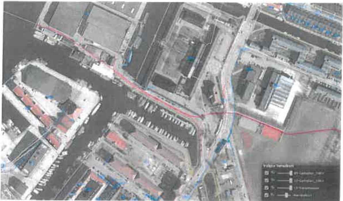
Bilag 1 Kortudsnit over Christiansholm, angiver kabeltracéer på Christiansholm til hørende Radius Einet A/S
