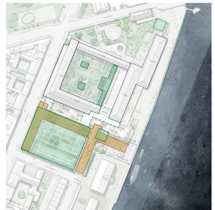
Eksisterende byggeri (markeret med orange) nedrives for at give plads til nybyggeri (markeret med grøn). Forbindelsesbygninger/gangbroer fra Amaliegade 44 til Esplanaden 50 er markeret med stiplet grøn linje. Illustration: Dorte Mandrup A/S.
