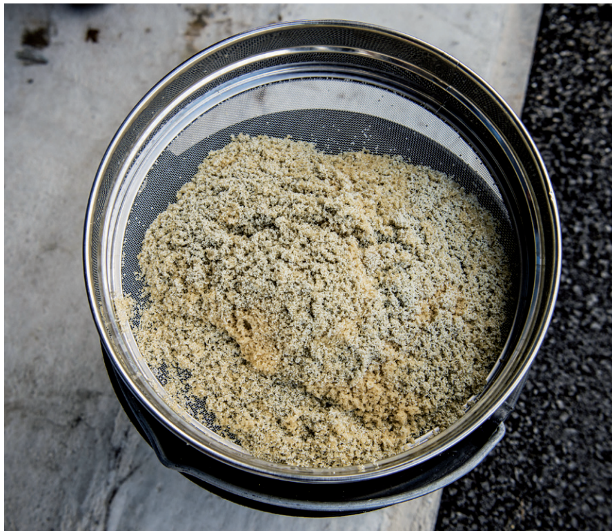
Pellets, som er kalkaflejringer på sandkorn, er et restprodukt fra produktion af blødere vand og kan bl.a. benyttes til jordforbedring.
