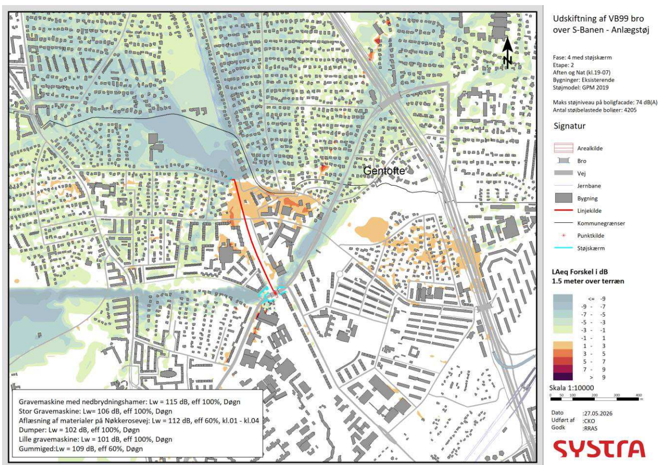
Figur 7-6 Støjkort, der viser forskellen af støjniveauet -L_Aeq i dB(A)- under nedbrydningen af VB99-broen i aften- og natteperioder under fase 4. Til højre signaturer og farveskala for A-vægtede støjniveauer.
