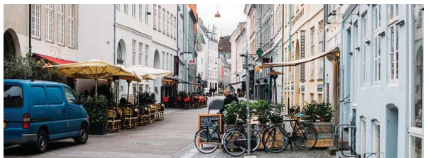
Eksempel på gågade med kørsel tilladt, hvor belægningen er i et niveau. Der er mulighed for afsætning, udeservering, beplantning og byinventar, Læderstræde
