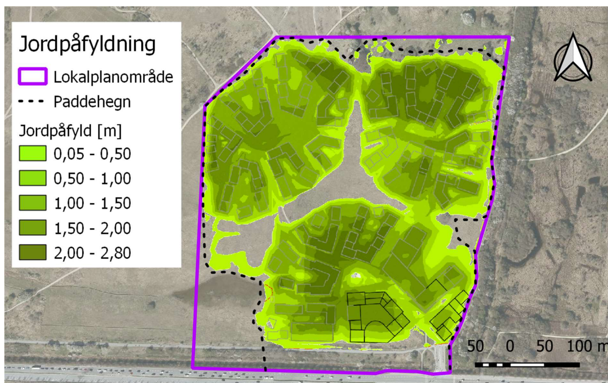
Figur 7.1 Placering af midlertidigt paddehegn (stiplet) og jordpåfyldning (grøn).
