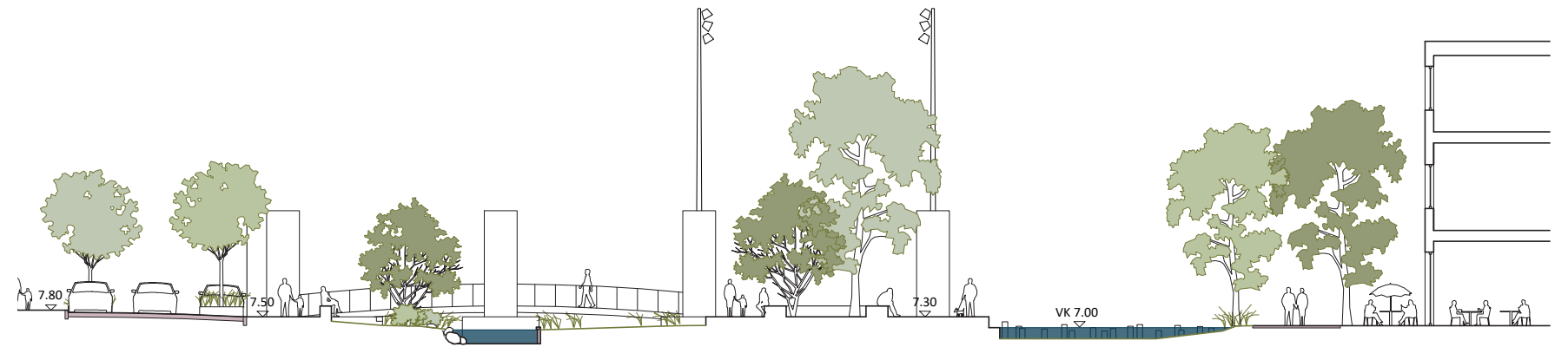
Snit, der viser, hvordan lavningerne i parkens kant fyldes og bliver til lave reservoirer.
