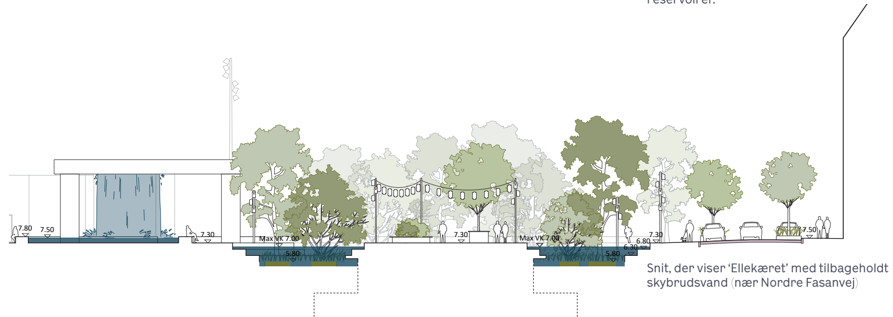
Snit, der viser, hvordan lavningerne i parkens kant fyldes og bliver til lave reservoirer.
