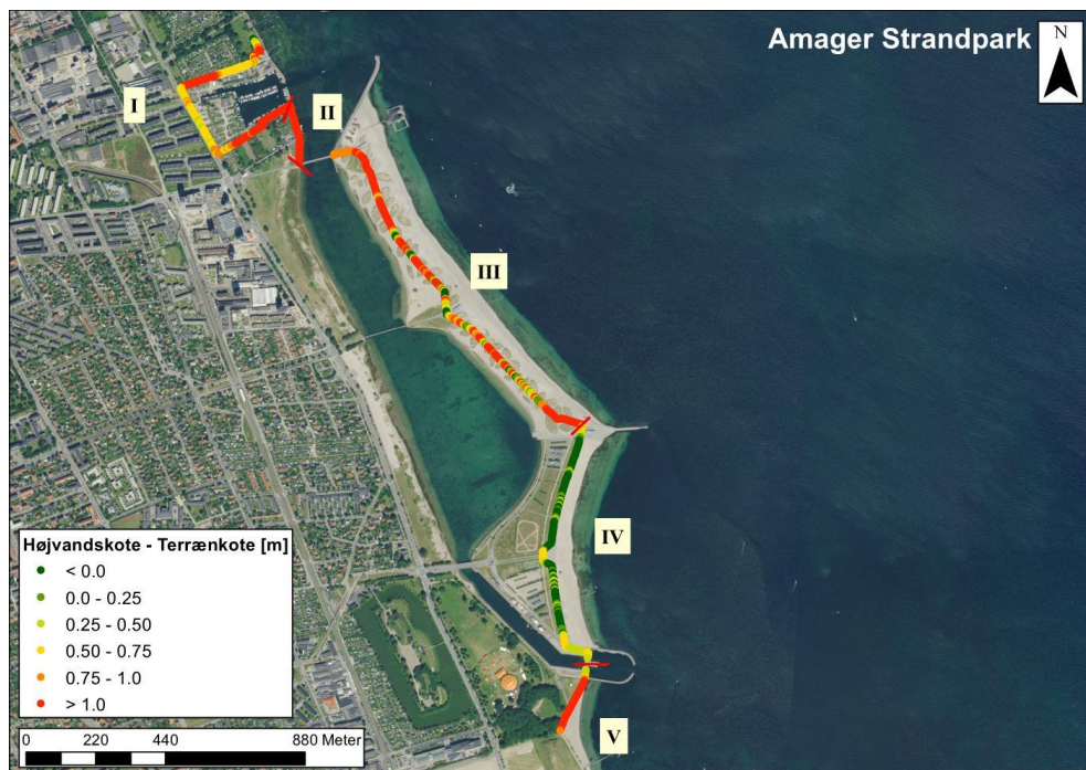
Figur 7-5 Kort for Amager Strandpark, "ydre" løsning med forskellen mellem dimensionsgivende højvandskoter (2,6 m) og eksisterende terrænkoter. Nuværende klitter har toppe til kote 2,3-3,6, mens den fremskudte sikring skal have højder på 2,7 - 3,2 m. Der er her forudsat en stigning i havvandsstand på 100 cm i perioden 1990-2100. Stiger havet 87 cm skal alle digehøjder og koter således reduceres med 13 cm.
