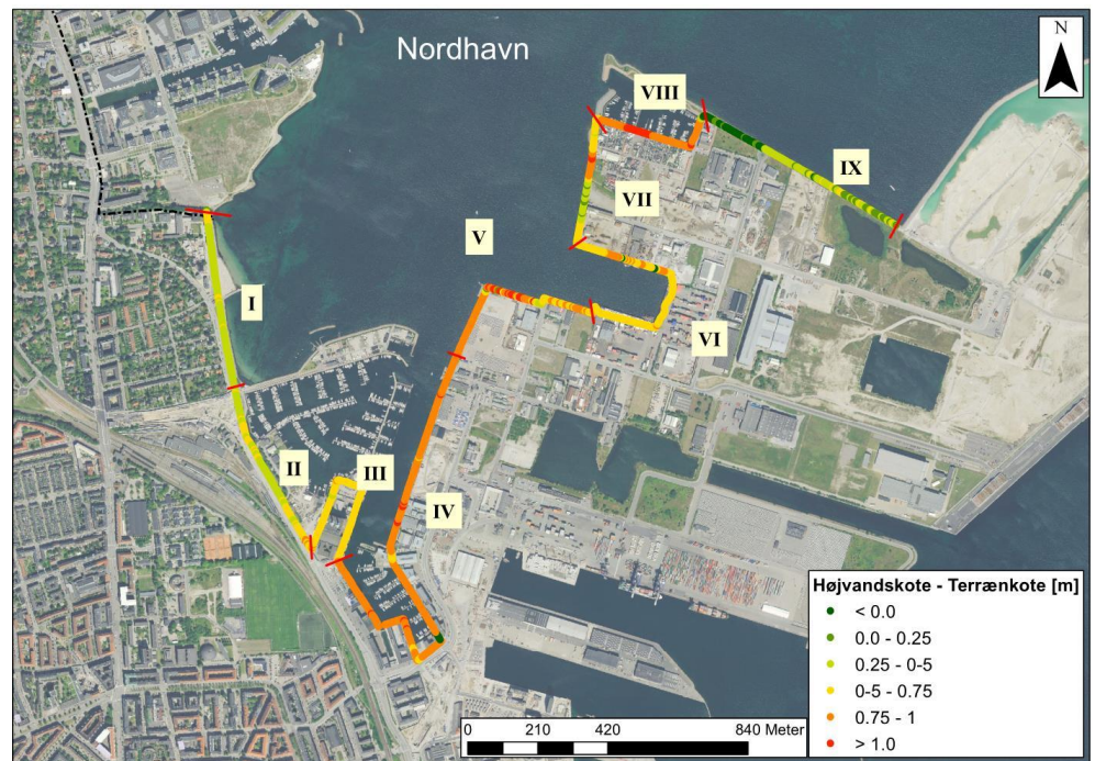
Figur 7-2 Kort for Nordhavn med forskellen mellem dimensiongivende højvandskoter (2,7 m) og eksisterende terrænkoter. Der er her forudsat en stigning i havvandsstand på 100 cm i perioden 1990-2100. Stiger havet 87 cm skal alle højder og koter således reduceres med 13 cm.
