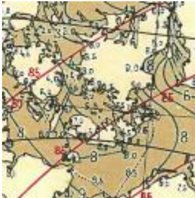
Figur 8-7 (zoom) Vandstanden (i fod) i Østersøen d 13/11 1872 kl. 12.00. Det ses, at vandstanden i Køge Bugt lige syd for København når 8 til 9 fod eller omkring +2,65 m. I Køge var vandstanden +9 fod kl. 12.00. Vinden er 90 fod/s (27,5 m/s) kl. 12 og 85 fod/s (26 m/s) kl. 14.
