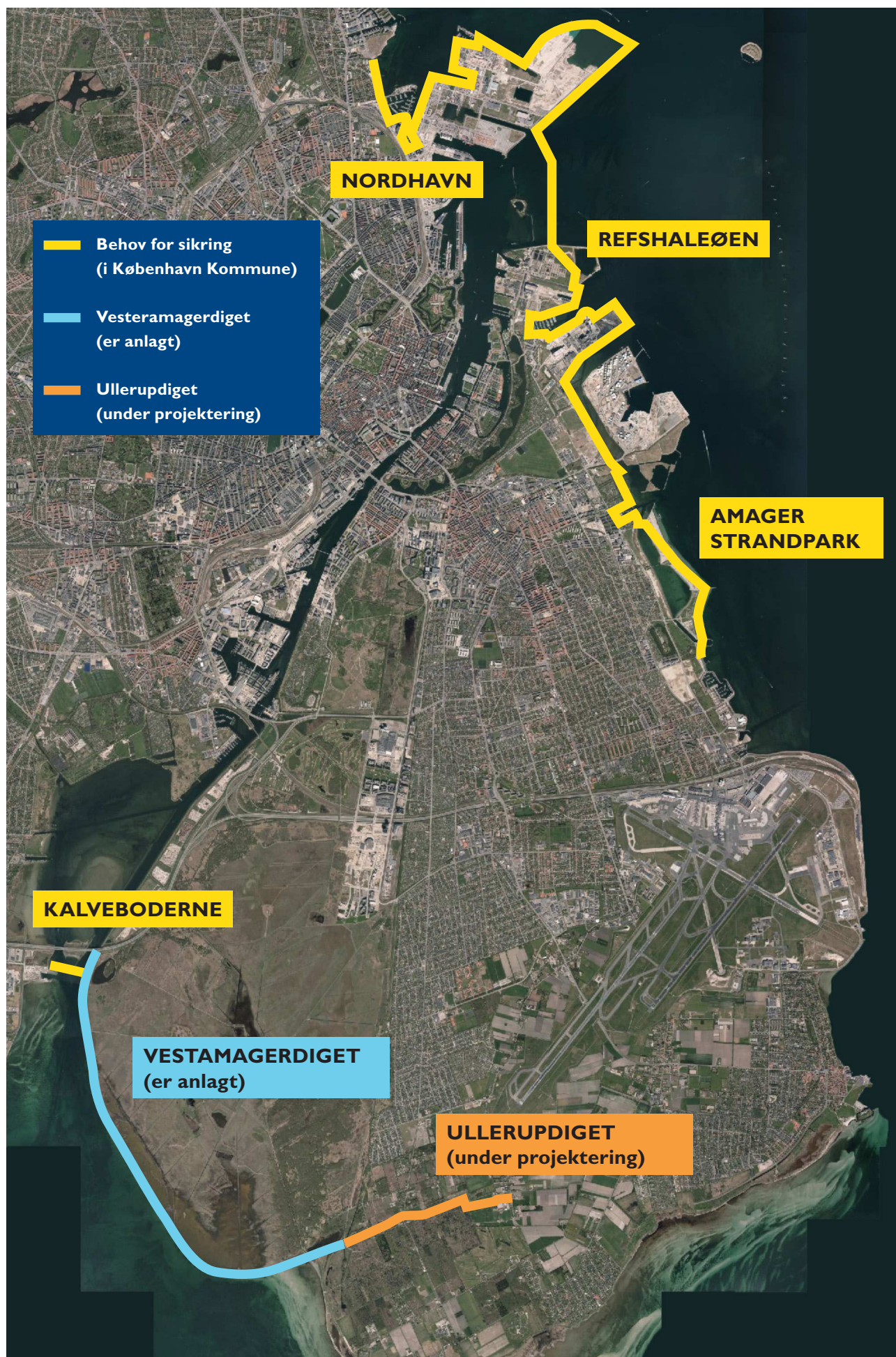
FIGUR 2: HOVEDGREB FOR STORMFLODSSIKRING I KØBENHAVN
