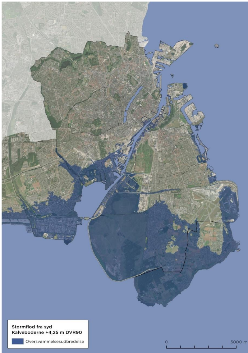
Figur 12: Forventet maksimal oversvømmelsesudbredelse for 4,25 m DVR90 middelvandstand svarende til en statistisk >2000-års hændelse i år 2020.
