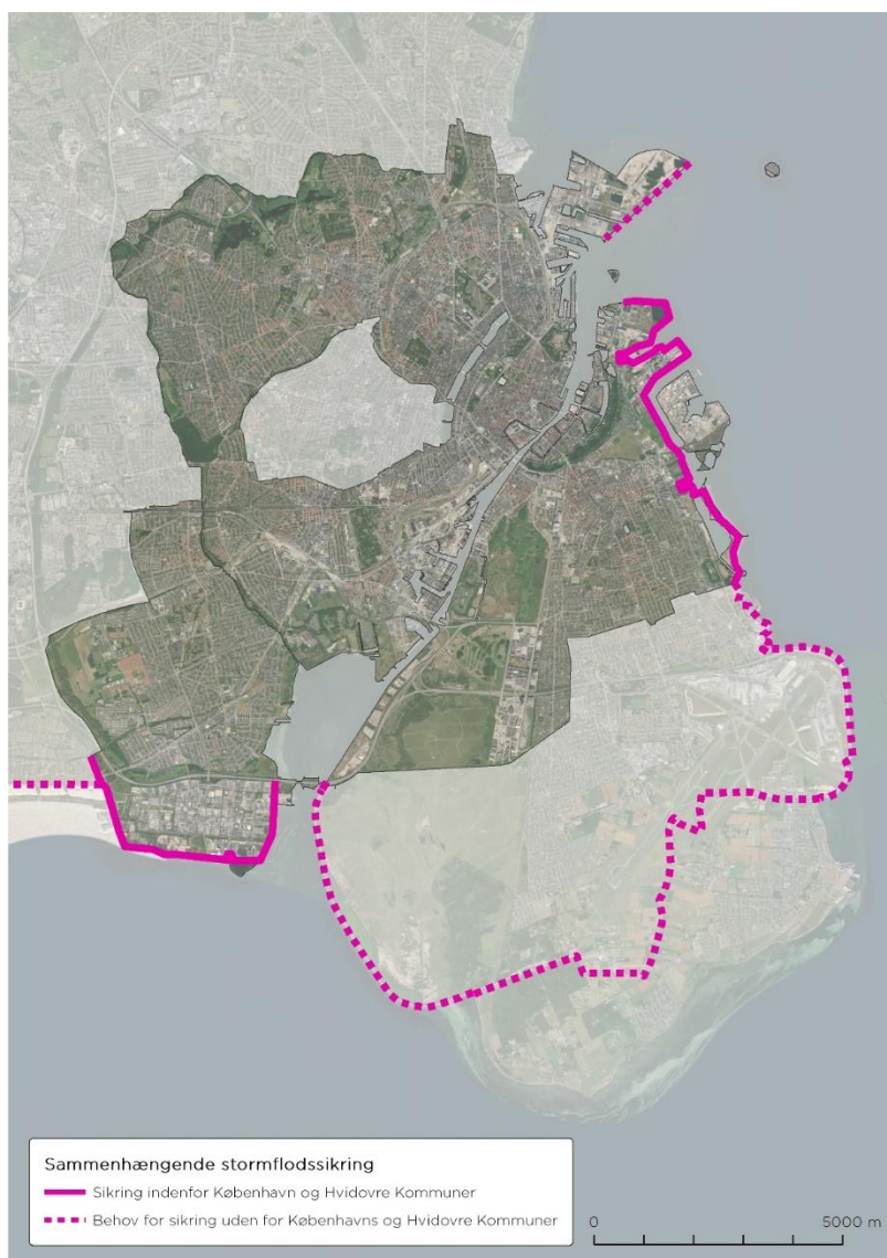
Figur 26: Nødvendig ekstra stormflodssikringsindsatser hvis København og Hvidovre Kommuner skal være sikret til kote 5,0 m DVR90.
