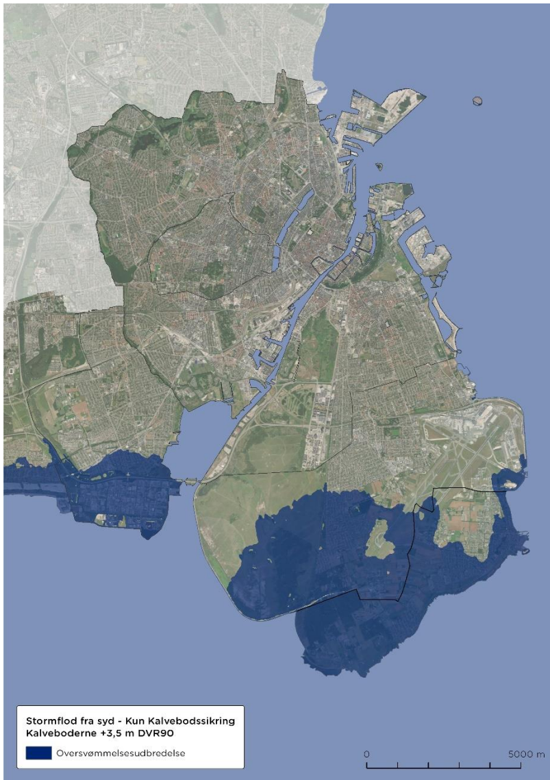
Figur 16: Oversvømmelsesudbredelse for 3,5 m vandstand svarende til det maksimale nuværende sikringsniveau.
