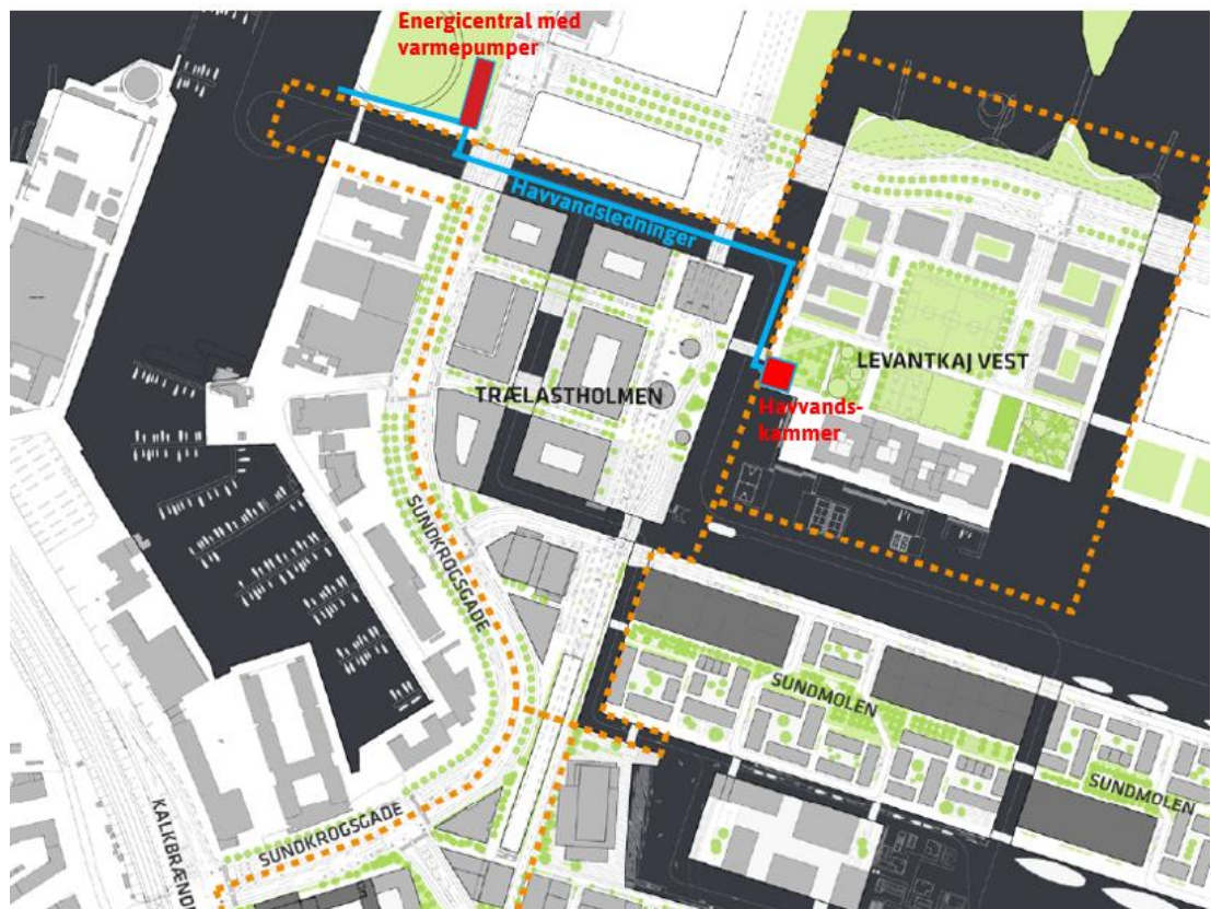
Figur 1: Områdeplan. Havvand tages ind i anlægget via havvandskammeret i Orientbassinet (mod øst) og ledes ud igen til Kalkbrænderiløbet (mod vest).
