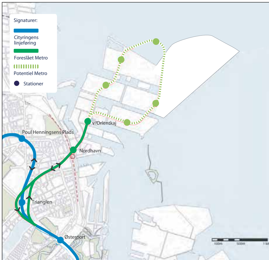
Figur 3.1 Nordhavnsmetroen. Linjeføringen for første etape, der er miljøvurderet her, er vist med mørkegrønt. Med stiplede lysegrønt er vist en mulig fremtidig udbygning og med blå, den allerede vedtagne Cityring.
