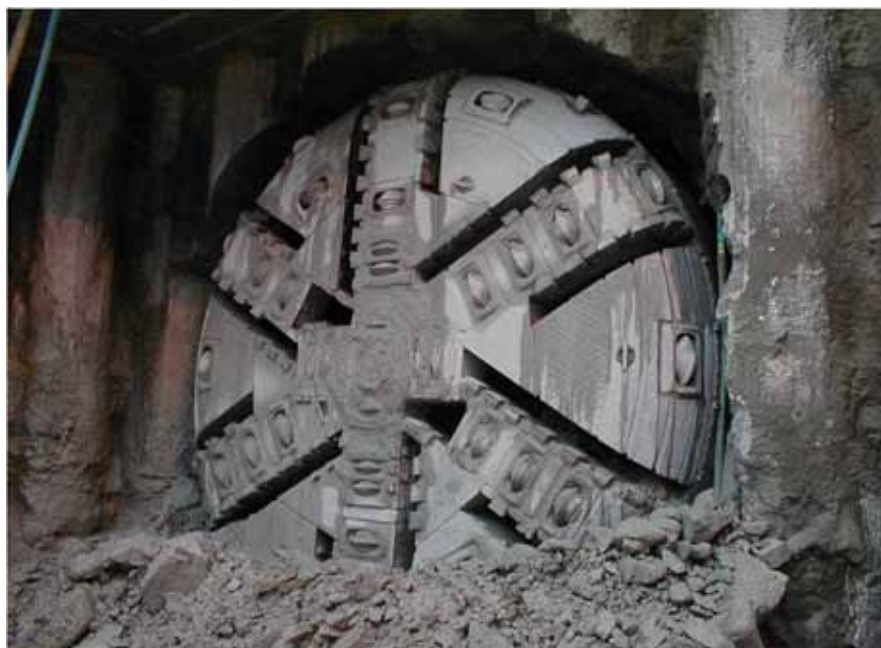
Figur 4.6 Frontskjoldet på en tunnelboremaskine.
