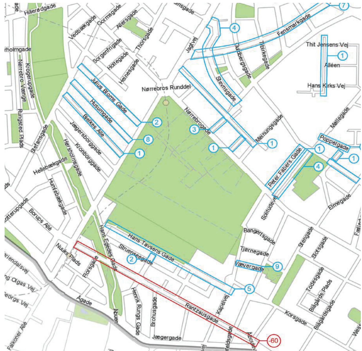
Figur 11 Forslag til erstatningsparkering for nedlagte P-pladser i Rantzaugade
