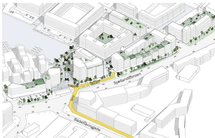
Skitse til placering af stibroforbindelse fra Bådehavnsgade med trappeadgang direkte til metropladsen og en cykelrampe langs vejen Sjællandsbroen.
