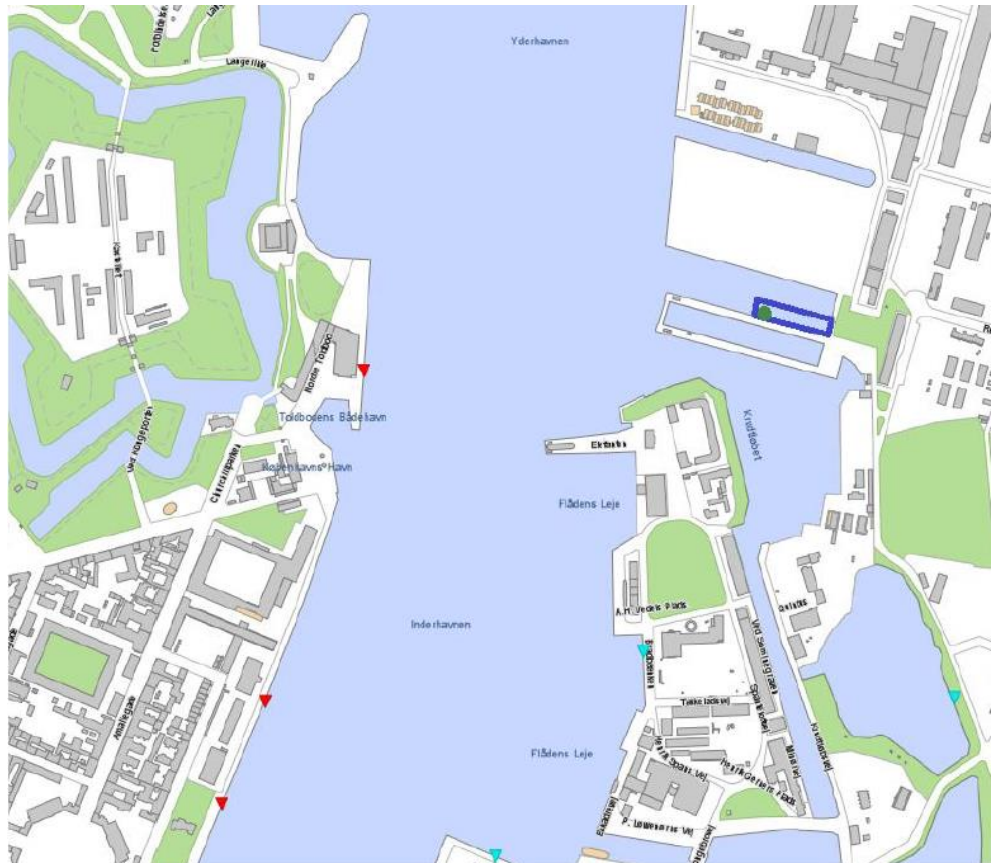
Figur 2 Eksempel på visning af overløbsbygværker til havnen – her omkring badezone Søndre Refshalebassin. Rød: overløbsvand, blå: separat regnvand (Københavns Kommune 2018a).
