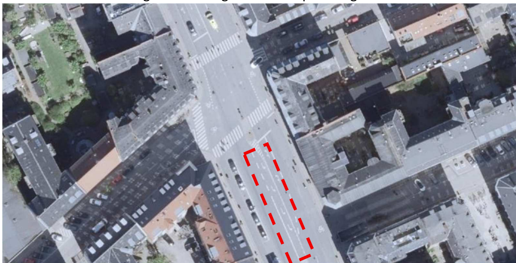
Figur 71: Markering af venstresvingsbanen der nævnes i punkt 5.
