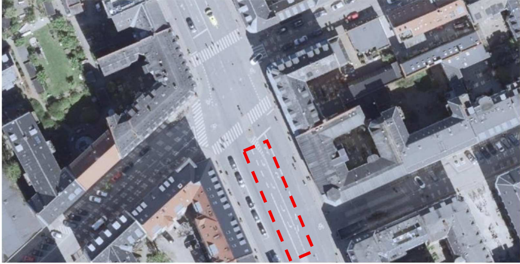
Figur 81: Markering af venstresvingsbanen der nævnes i punkt 5.
