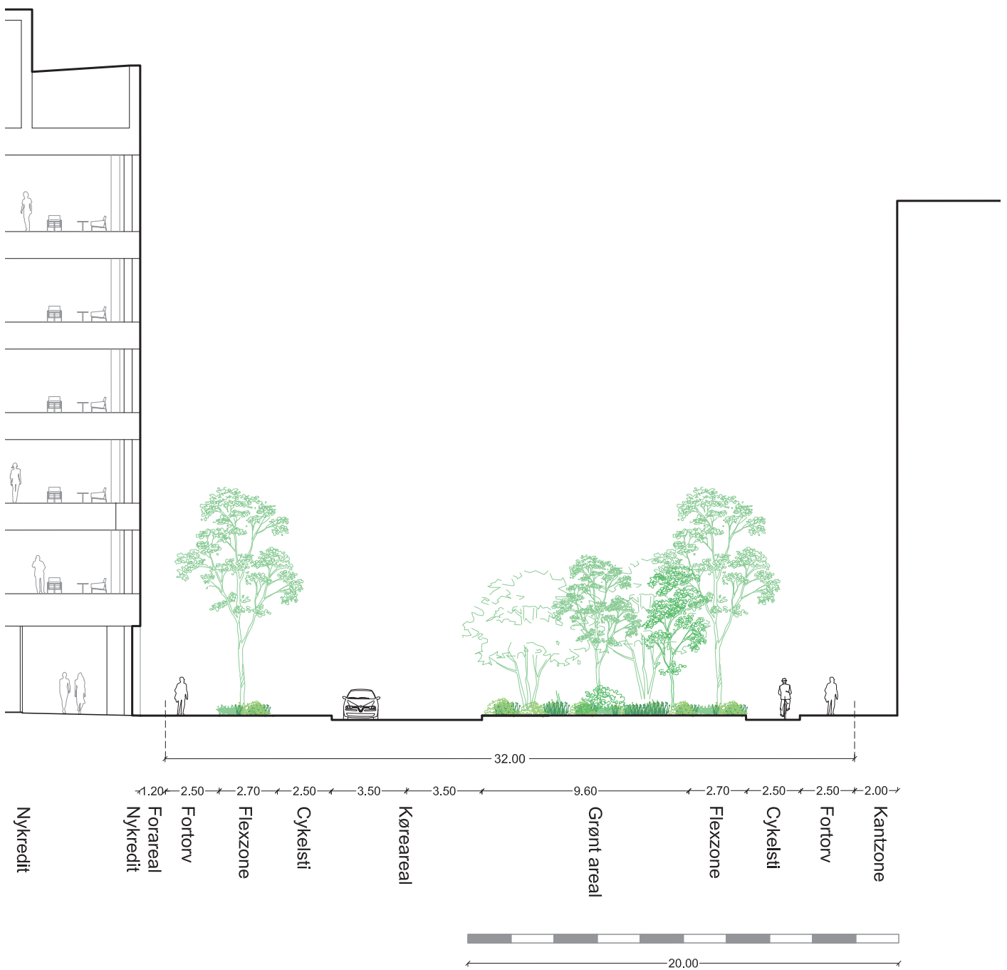
Principsnit af Sundkrogsgade anlagt med 2 spor
