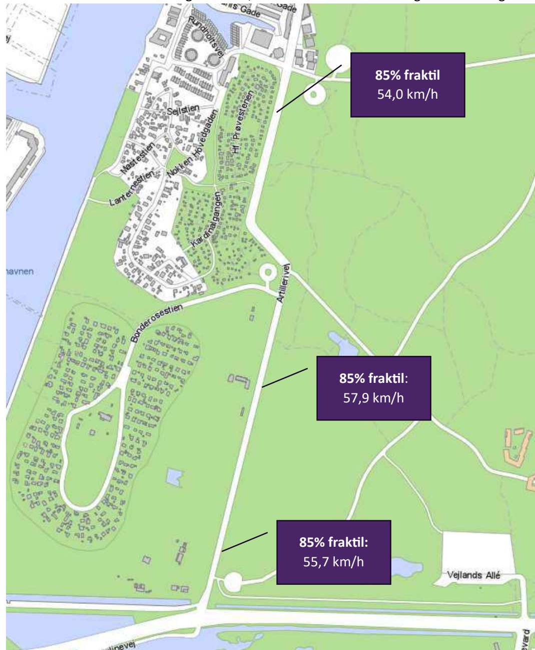
Ved alle tre tællesnit ses det, at 85% fraktilen er højere end den tilladte hastighed på strækningen.
