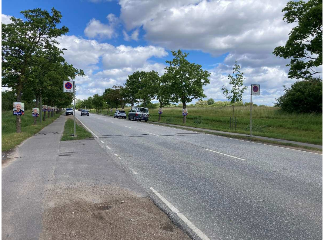
Figur 3: Eksempel på en af de tre trafiktællinger fra foranalysen, udført med slanger spændt ud over kørebanen. I øvrigt ses parkerede biler, lige inden for standsningsforbudszonen.
