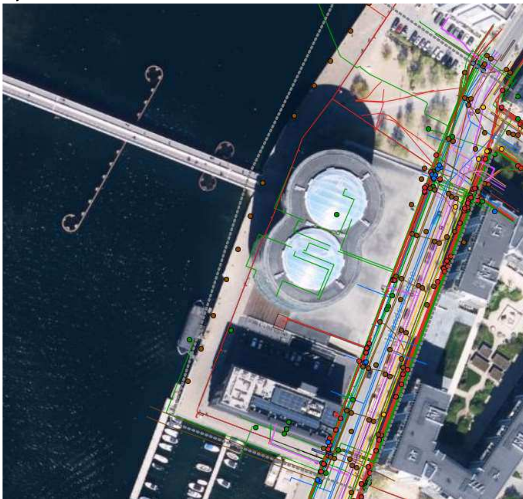
Figur 34: Illustration af omfanget af ledninger i området omkring Bryggebroen.
