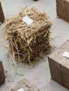
Halm Et velkendt biogent materiale er halm. Udover materialets lethed og isolerende kvalitet bliver det også produceret som halmballelevægge. Materialets akustiske egenskaber skaber sanseligt stimulerende rum.
