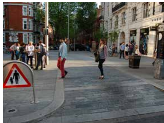
Hævet brostensflade og skiltning signalerer færdsel på fodgængeres præmisser
