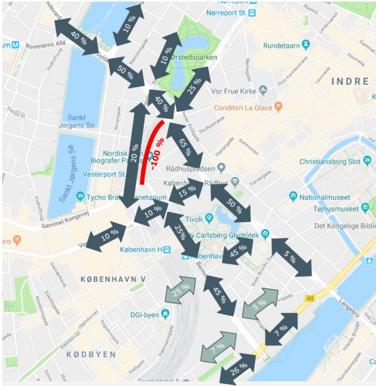
Figur 14 Omfordeling af trafik ved lukning af Hammerichsgade. 15 % vurderes at køre uden om det aktuelle analyseområde efter lukningen.
