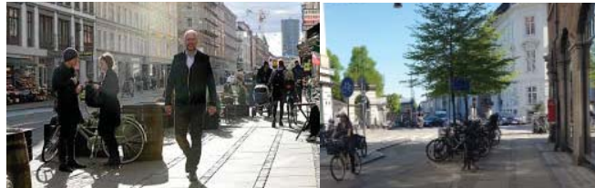
Lokale indsnævninger af kørebane og lokalt udvidede fortove giver plads til gående og handlende, Istedgade. Indsnævring af gadeprofil lokalt giver plads til træer og cykelparkering, Møntergade.
