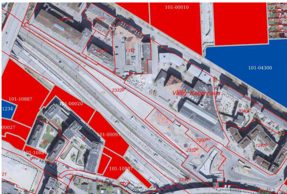
Figur 18.1: Kortudsnit over forureningskortlagte arealer i umiddelbar nærhed af projektområdet. Røde markeringer angiver forureningskortlagte arealer på vidensniveau 2 (V2) og blå markeringer angiver forureningskortlagte arealer på vidensniveau 1 (V1) /2/.
