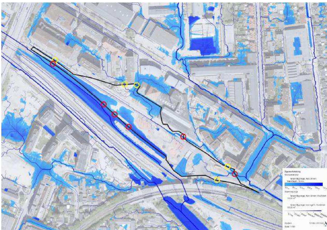
Figur 12.2: Scalgoanalyse af ekstremregn. De gule cirkler angiver eksisterende strømningsveje ind i området, mens de røde cirkler angiver eksisterende strømningsveje ud af området /bilag 6/.
