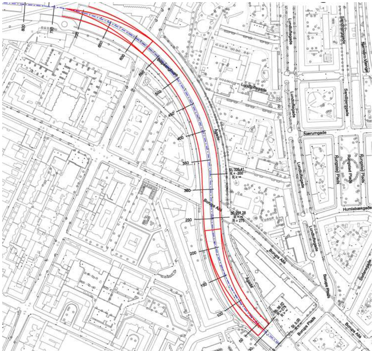
Figur 1. Plan for kort tunnel mellem Borups Plads og S-banen. Kan ses i større format i bilag 1.
