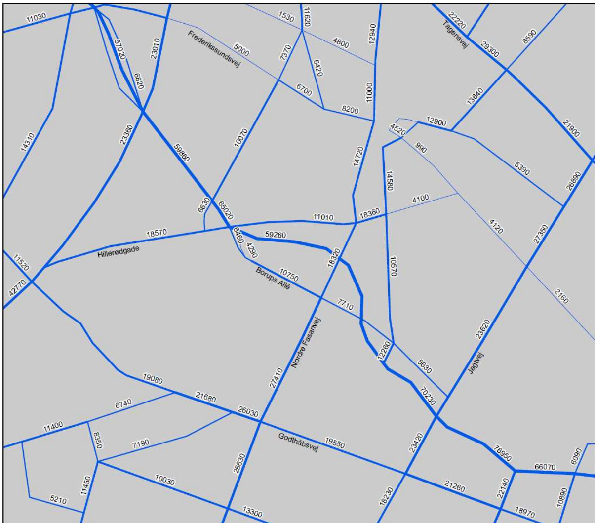
Figur 8. Basis 2035. Beregnede trafikbelastninger på vejnettet omkring Bispeengbuen, antal køretøjer per hverdagsdøgn 2035
