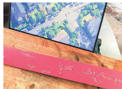
Her ses procesbillede af det gravografiske arbejde, med at overføre asfalttegn fundet i ortofoto, over på kabeldækbånd.
