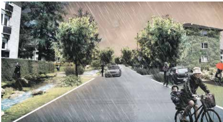
Illustrationen viser Kirsebærhaven i en almindelig regnvejrssituation, hvor vandet ledes væk i det grønne bånd til venstre i billedet. Ved et skybrud vil det grønne bånd fyldes yderligere, så der ikke sker oversvømmelse.
