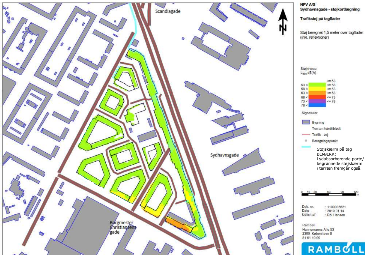
Figur 13 Vejstøj 1,5 meter over tagflader.
