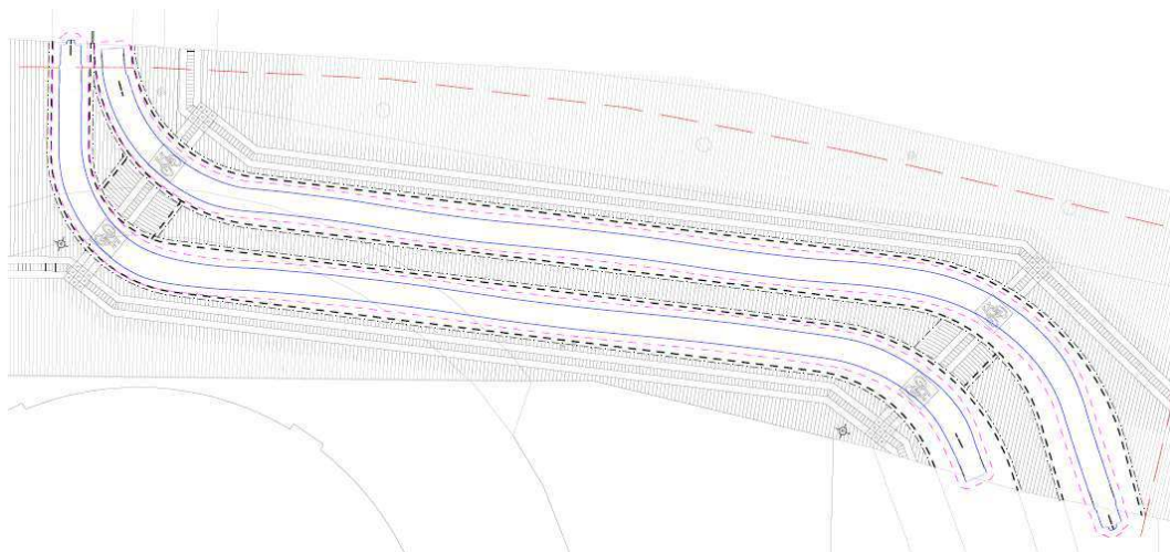
Figur 49: Illustration af efterprøvning af arealbehov for ladcykel for løsningsforslag 2. Magenta stiplede linje er arealbehovet inklusiv 30 cm sikkerhedstillæg
