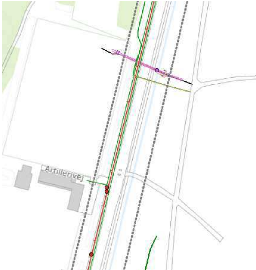
Figur 20: Eksempel på omfanget af ledninger langs Artillerivej. Her et udsnit af et af to steder, hvor der er ledninger der krydser Artillerivej.
