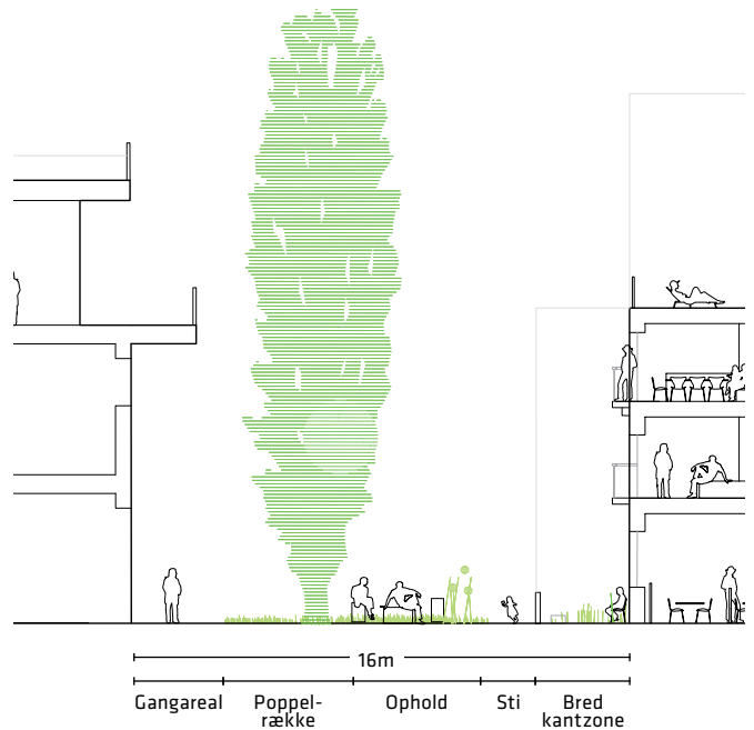
Fig. 8.5.b: Snit gennem det grønne forløb. Snittet viser gangareal ved facade, grønt område i midten med poppelrække og kantzoner
