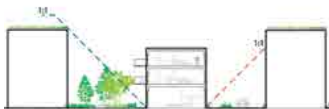
Fig. 6.6.: Skrå højdegrænseplaner: Illustrationen viser at højdegrænseplanen på 1:1 overholdes mod en side i forhold til bygningen i midten
