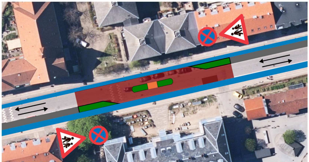
Figur 30. Princip for skolezone ved Heibergskolen, hvor standsning er forbudt, og eleverne kan krydse vejen via en midterhelle (og eventuelt et fodgængerfelt med skolepatrulje).
