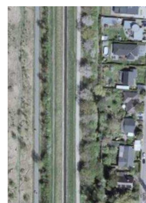
Kanalerne beskytter Ørestad mod oversvømmelser ved at lede regnvand til havnebassinet. Ved høj vandstand opsamlers søer og vådområder på Amager Fælled og Vestamager det overskydende vand Kort: Klimadastyrrelsen ortofoto, CC-BY 4.0
