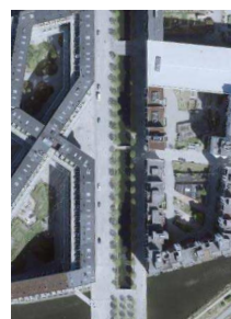
Kanalerne beskytter Ørestad mod oversvømmelser ved at lede regnvand til havnebassinet. Ved høj vandstand opsamlers søer og vådområder på Amager Fælled og Vestamager det overskydende vand Kort: Klimadastyrrelsen ortofoto, CC-BY 4.0
