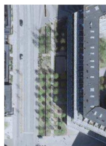
Kanalerne beskytter Ørestad mod oversvømmelser ved at lede regnvand til havnebassinet. Ved høj vandstand opsamlers søer og vådområder på Amager Fælled og Vestamager det overskydende vand Kort: Klimadastyrrelsen ortofoto, CC-BY 4.0
