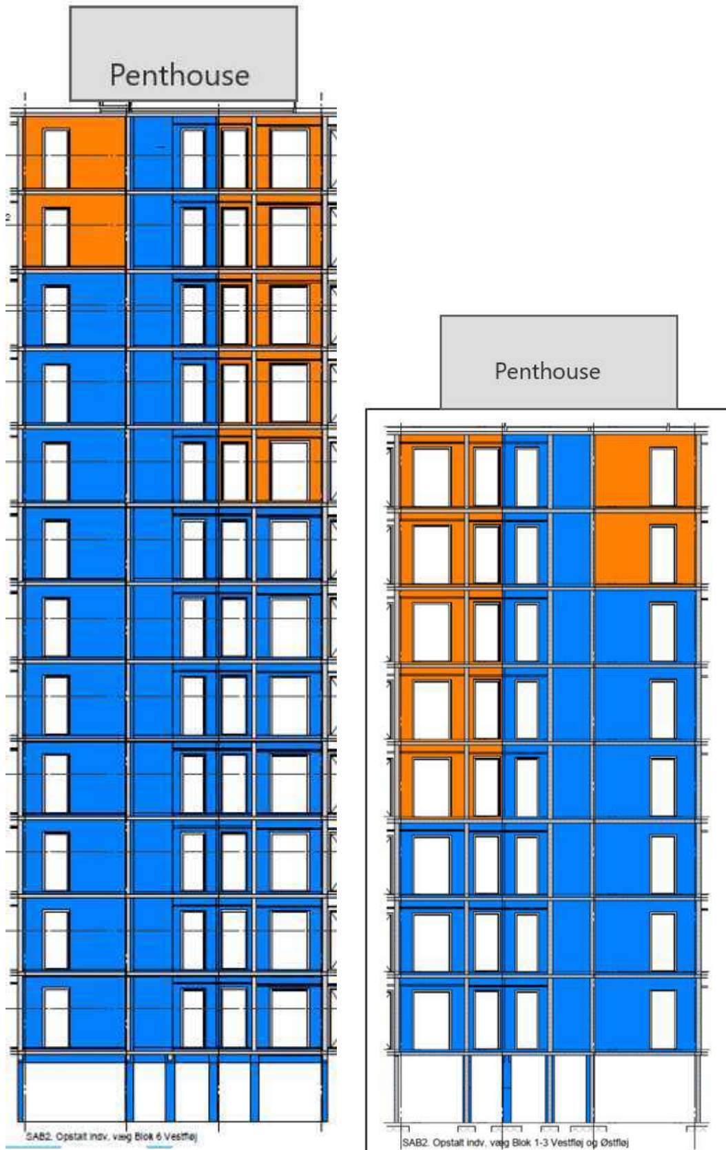
Figur 3.5. Opstalt af langsgående stabiliserende væg for SAB2-6 og SAB2-3. Blå farve angiver beton, mens orange angiver slag-geplader, idet det bemærkes at længdevæggen ikke er lodret bærende.
