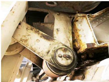
Figur 9: Baskuleringsarm, -rulle og -horn i lukket tilstand.
