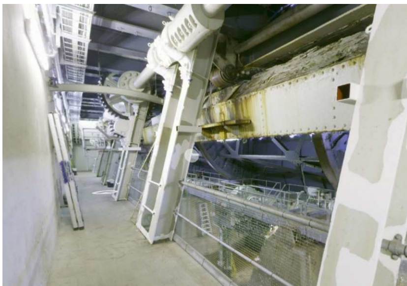
Figur 9: Baggang Sjælland med baskuleringsmaskineri som det er i dag.
