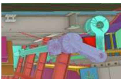
Figur 11: De med violet markerede dele skal fjernes for at give plads til den kommende aktuator.
