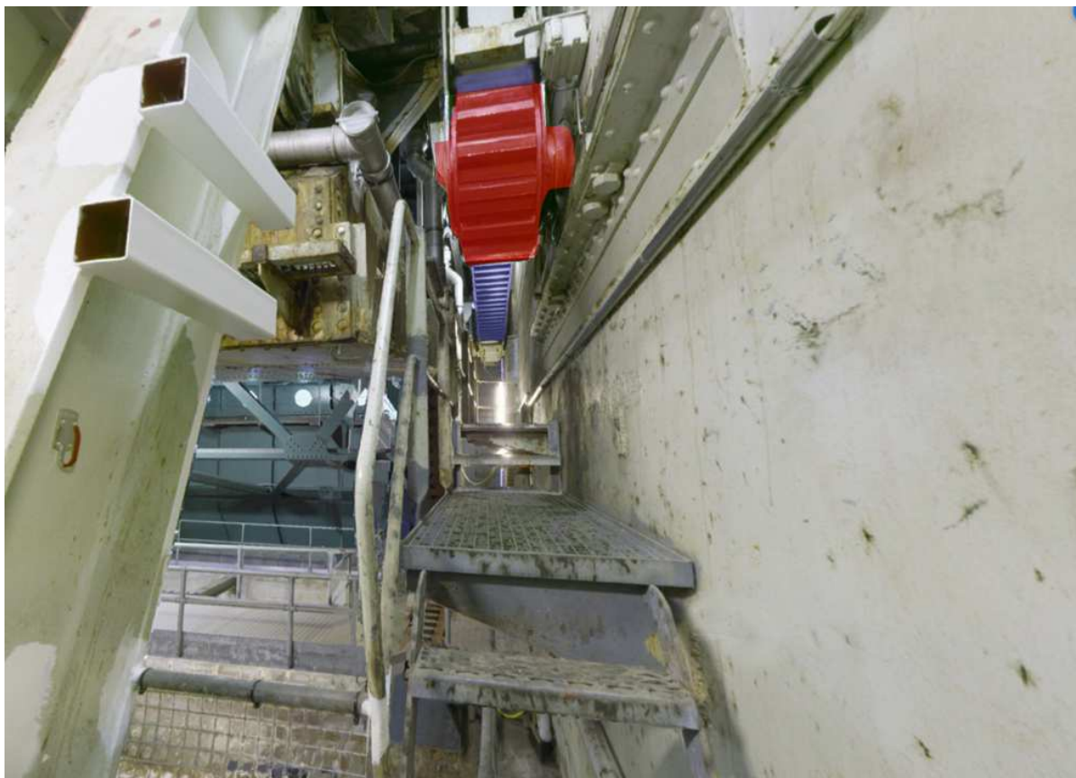
Figur 21: Klapkælder København, syd. Drivhjul (rødt) og tandstang (violet) set fra baggangen skråt nedefra. Foto.
