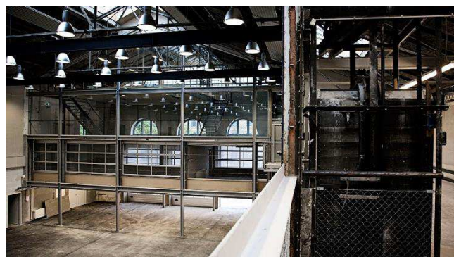
To gamle remisehaller på Enghavevej er transformeret til et kulturelt samlingssted, hvor dagslyset bliver sikret gennem ovenlysvinduer. Den indtejrede klimapåvirkning for projektet er 2,32 kg CO 2 /m 2 år, hvoraf vinduer og tag har de største bidrag. Foto: BBP Arkitekter, 2013 Kilde: Transformation - for klimaet, økonomien og bygningsmassen, Realdania, 2022.
