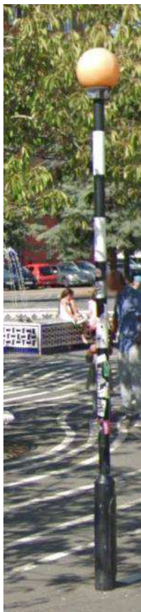
Blinkende lys på mast – Armaturnavn: AMT Fodgænger skilt fra England (Belisha Beacon) (2 stk., et på Den Røde Plads og en på Den Sorte Plads, LED, 23W)
