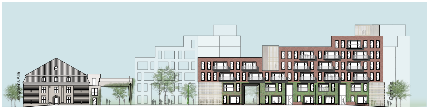
Opstalt langs den tværgående forbindelse set mod øst. Bag det bevaringsværdige pakhhus bevares en eksisterende tagkonstruktion, som vil danne tag over en af de nye lokale pladser. Illustration: Holscher Nordberg.
