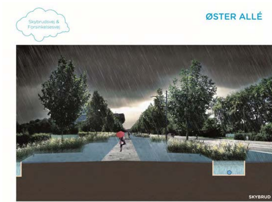
Figur 20 Øster Allé kan omdannes, således at den dels kan forsinke store vandmængder, dels kan aflede vand mod Blegdamsvej, når forsinkelsesvoluminet er fyldt. Se bilag 0.3-273
