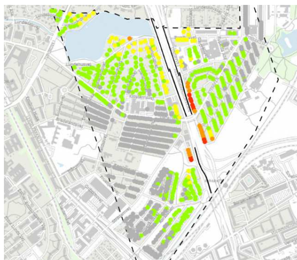
Støj kort med støjbelastede boliger alene i forhold til støjdbredelsen fra Helsingørsmotorvejen.
